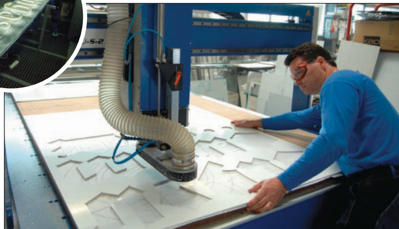
Produktionsleiter Tom Thiermann schneidet Buchstaben mit Hilfe einer CNC-Fräsmaschine aus (unteres Foto) und schleift Acrylglas-Leuchtreklame (kleines Foto oben) Foto: maxpress
