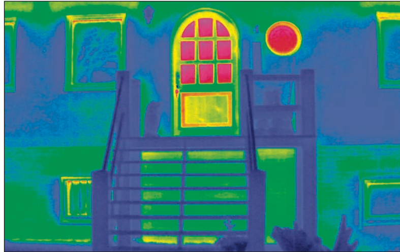
Mit Hilfe der Infrarot-Thermografie werden Temperaturunterschiede auf Oberflächen optisch dargestellt Foto: Stadtwerke Schwerin
