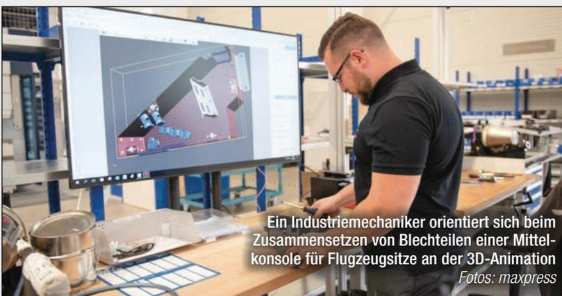
Ein Industriemechaniker orientiert sich beim Zusammensetzen von Blechteilen einer Mittelkonsole für Flugzeugsitze an der 3D-Animation
