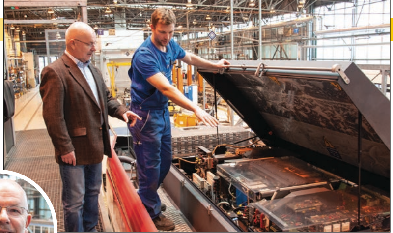
Mechatroniker Maik Schwabe zeigt Gert Rudolf die Fahr- und Bremselektronik auf dem Dach einer Straßenbahn Foto: maxpress
