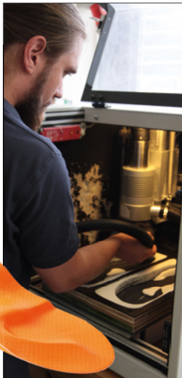
Mit einer speziellen Fräse wird die Einlage individuell angefertigt Fotos: STOLLE
