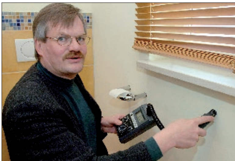
Bausachverständiger Dipl.-Ing. Hartmut Schütt prüft mit einem Messgerät die Wandfeuchte unter einer Fensterbank Foto: max
