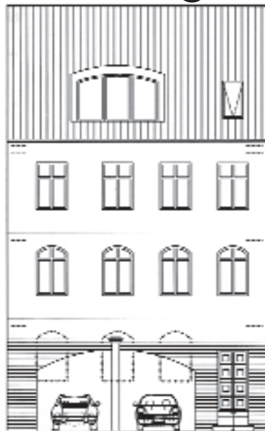
Das Erdgeschoss der Severinstraße 15 wird zur Einfahrt in die Tiefgarage umgebaut
