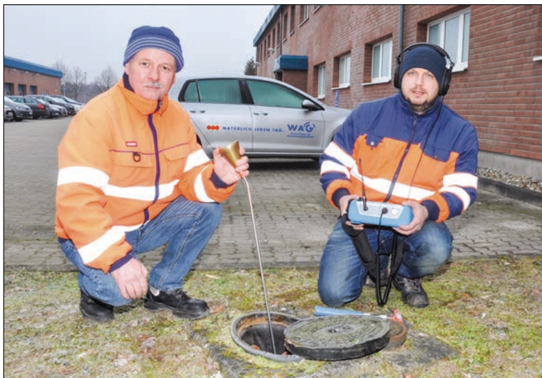
Guido Brüggemann und Benjamin Walter (r.) prüfen mit verschiedenen technischen Hilfsmitteln an einem Hydranten, ob es Hinweise auf Strömungsgeräusche gibt Fotos: maxpress/ba
