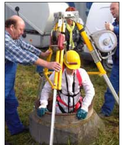
Sicherheit geht vor: Dreibock mit Höhensicherungstechnik Fotos: WAG/maxpress
