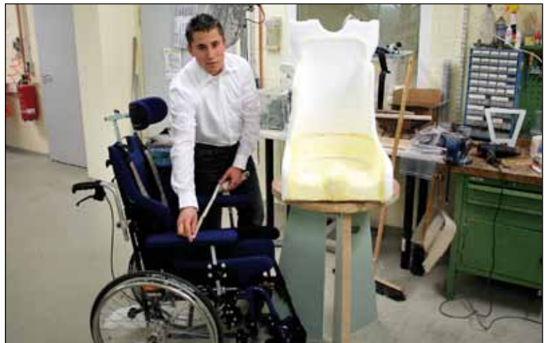
Stolle-Mitarbeiter Carsten Matthies misst den Rollstuhl aus. Für diesen wird dann mithilfe eines Gipsmodells eine Sitzschale maßgenau angefertigt Fotos: Stolle
