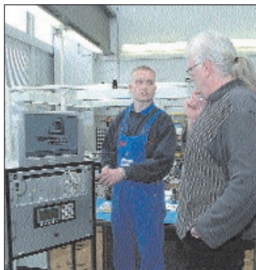
Andreas Luchs präsentiert Thomas Mundri vom Prüfungsausschuss sein Abschlussprojekt, einen mobilen Prüfstand für die Fahrgastmonitore der Nahverkehrsbusse
