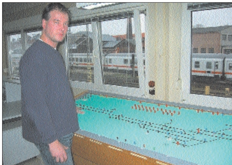
Die Gleisanlagen des Bahnhofs im Kleinformat. Jens Marquardt kann mittels der Funktastknöpfe am Stellertisch alle 18 Weichen bedienen Foto: hs
