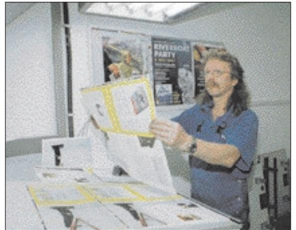
Drucker Hans-Dieter Walter bedient die „Karat 74“. Die Digitaldruckmaschine schafft es, 10.000 Bögen in einer Stunde zu drucken.
